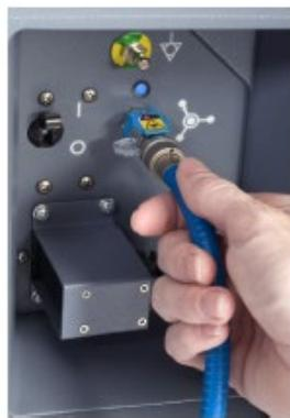
참고: 각 시스템 케이블에 부착된 보호용 금속캡은 시스템에 연결되어 있지 않은 경우에 항상 케이블 종단에 설치되어 있어야 합니다.
