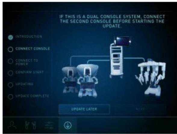
보조 Surgeon Console 이 있는 경우 System 은 사용자에게 그것을 연결하라는 메시지 창을 표시합니다. Dual Console System 인 경우 보조 Console 파란색 광섬유 Cable 을 연결합니다.
