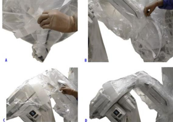
그림 30 드레이프 스트랩 위치를 확인하고 끝을 분리한 다음(A와 C) 기구 팔 주변에 감고 고정합니다(B 및 D).
