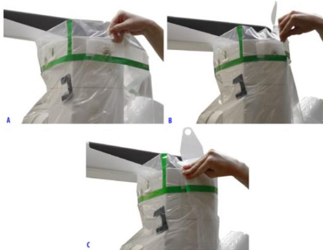
그림 23 금속 디스크를 적색 자석 소켓(A)에 부착하고 플라스틱 자락을 접어 눌러 고정합니다(B 및 C)
