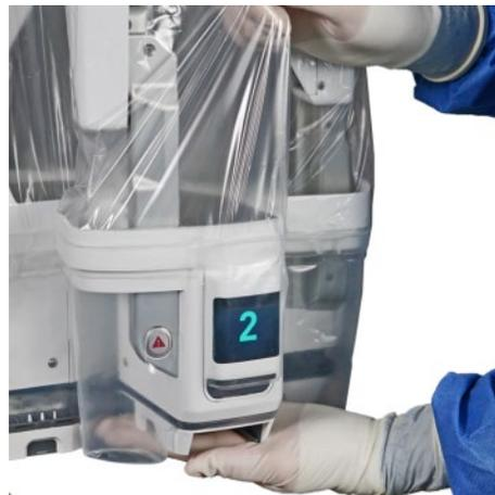
그림 36 드라이브 드레이프 조정 및 멸균 어댑터 설치
