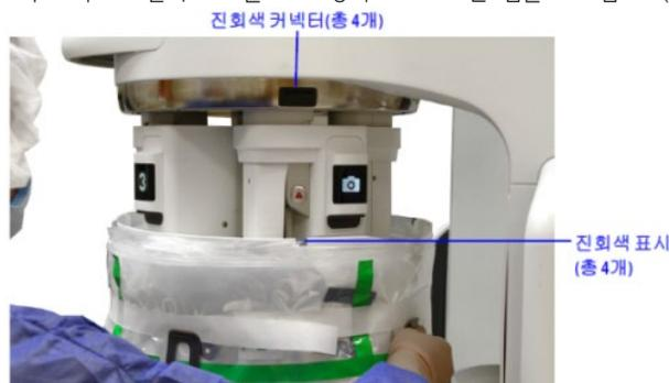
그림 12 진회색 표시 네 개를 진회색 커넥터에 맞게 배치하고 드레이프를 기구 드라이브 주변에 위치시킵니다.
