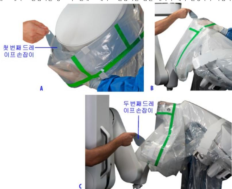
그림 19 드레이프를 기구 클러치 버튼 위를 지나 당기고(A), 기구 팔 상단 위를 넘어 당긴 후(B), 두 번째 드레이프 손잡이를 잡습니다(C)
