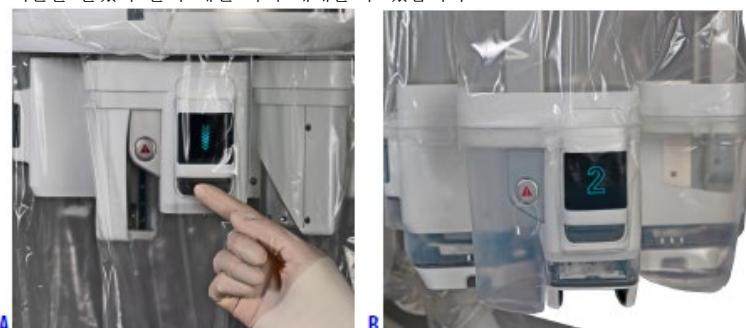
그림 35 드라이브 클러치 버튼(A)을 눌렀다 빨리 떼면 기구 드라이브가 기구 드라이브 드레이프(B)로 확장된다.
