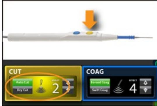
활성화된 모드의 표시화면에 불이 들어온다. 작동 신호음이 울린다. 예: 모노폴라 모드, CUT 표시
