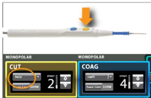
항상 녹색으로 하이라이트 표시된 선택모드가 작동합니다. 손가락 스위치의 노란색 버튼을 계속 누르면, *Auto Cut*(자동 절단) 또는 *Dry Cut*(건식 절단)이 작동합니다.
