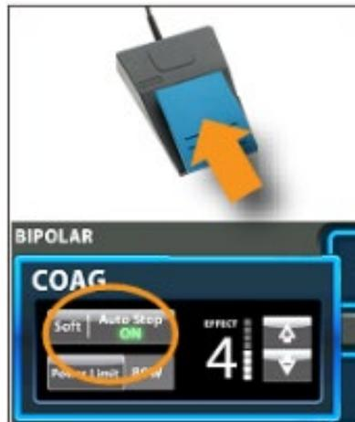
항상 녹색으로 하이라이트 표시된 선택 모드가 작동합니다. 파란색 페달을 계속 밟으면 *Soft Coag (연조직 응고)* 또는 *Soft Coag with Auto Stop(자동정지기능을 수반한 연조직 응고)*이 작동합니다.
