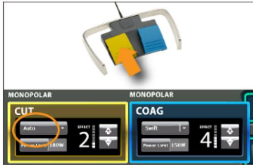
항상 녹색으로 하이라이트 표시된 선택모드가 작동합니다. 노란색 페달을 계속 밟으면, *Auto Cut*(자동 절단) 또는 *Dry Cut*(건식 절단)이 작동합니다.
