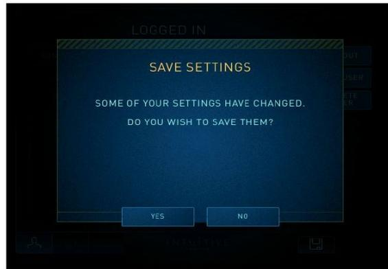
시스템에서 절차의 끝을 인식할 때 자동 로그아웃이 발생합니다. 시스템이 자동으로 로그아웃하면 설정에 대한 변경 내용이 저장되지 않고 사용자가 사용할 수 있는 설정에 대한 저장되지 않은 변경 내용이 모두 손실됩니다.
