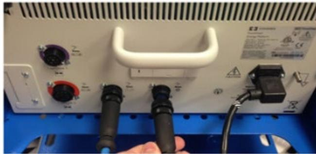
나) 시스템의 케이블 끝을 비전 카트(그림 16)의 전기 소켓 Energy 3 개 중 하나에 연결합니다. 케이블 커넥터의 빨간점을 소켓 우측의 빨간점과 나란히 일치시킵니다. 케이블이 제대로 맞물리면 찰칵하는 소리가 납니다. 케이블 커넥터를 부드럽게 당겨 케이블이 완전히 자리 잡았는지 여부를 확인합니다. 전기수술장치(ESU)와 시스템이 켜지면 해당하는 LED 표시등에 불이 들어옵니다.
