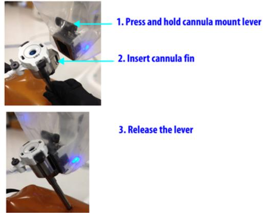
그림 7 cannula 를 arm 에 docking 한 모습
