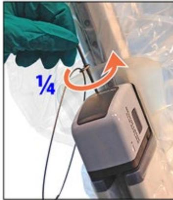
그림 1.3 grip 을 수동으로 여는 동안 grip release 도구가 계속 맞물려 있는 상태를 유지
