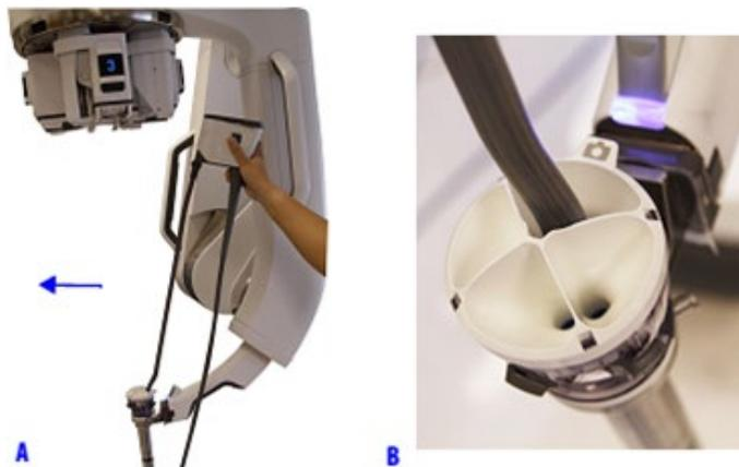
EntryGuide Lumen 에 Camera Tip 배치(A 및 B) - Camera 위 모드의 예
