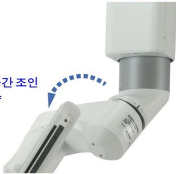
그림 3.6 patient clearance joint 위치 예시
