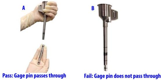
그림 4.6 gage pin 합격 / 불합격의 예
